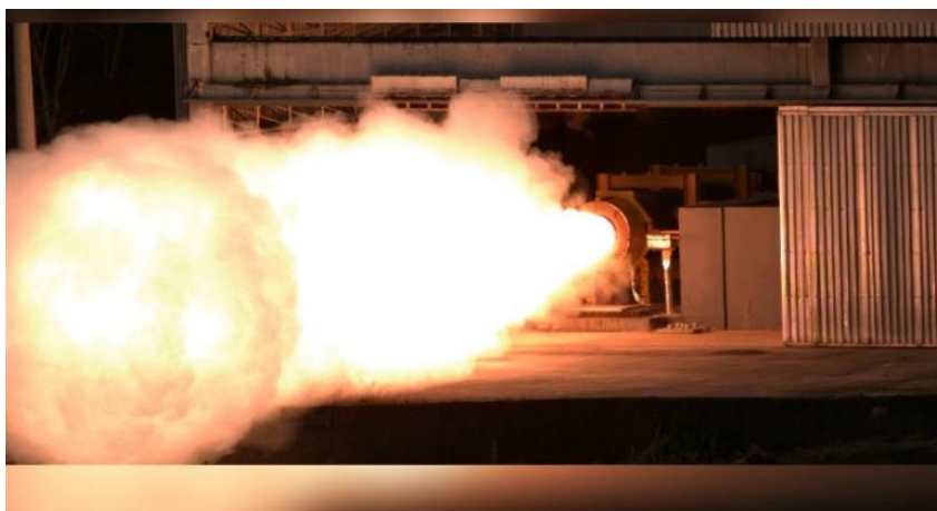
Foto 1 – Ensaio de tiro em banco do S50
